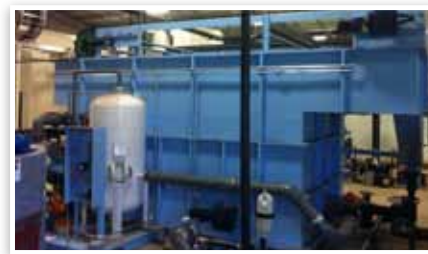
Unidad DAF usando un sistema convencional de reciclado
